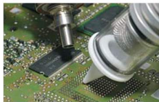
Limpieza Pad Punta de teflón sin fricción, que evita daño en el pad
